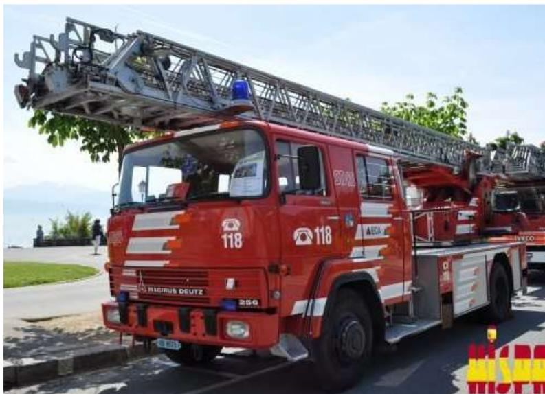
Le camion échelle MIKA 3 de 1958 a plus de 20 ans et sa puissance et sa technique sont dépassées. Le CR décide de se procurer un **camion échelle MAGIRUS 256 30 mètres automatique, 256 CV avec nacelle**. Ce sera le premier camion-échelle MAGIRUS de 256 CV destiné à la Suisse. Il devra être homologué par la Confédération.
